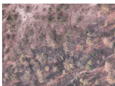
Figura T17-2 Extracción del polígono de copa por estereoscopía usando fotografías aéreas digitales (Bosque dipterocarpo seco en Kampong Thom, Cambodia)
