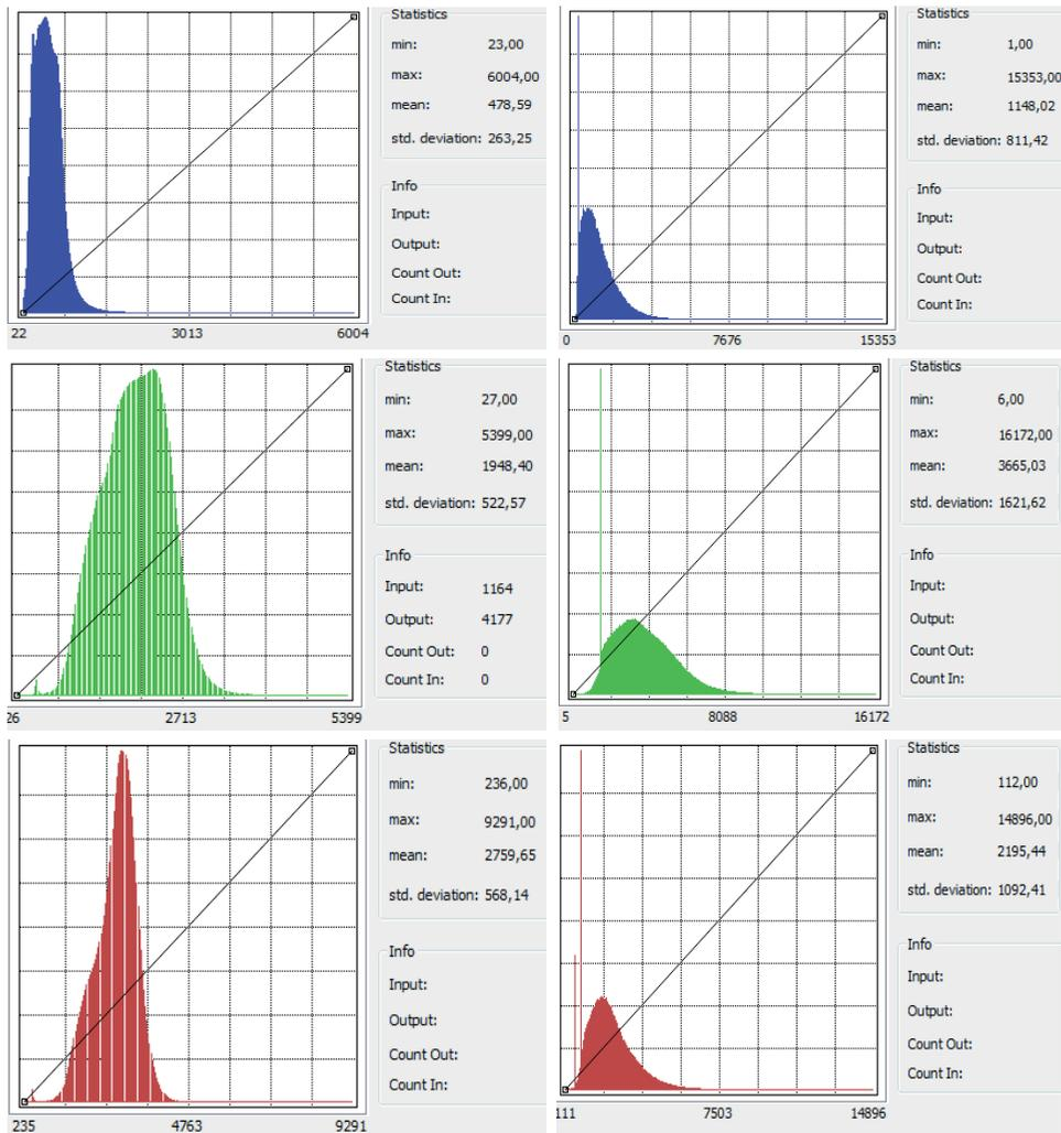
Figura 3. Histogramas de las bandas espectrales de la imagen de referencia para la normalización, correspondiente al primer año del análisis vs. histogramas de la imagen normalizada correspondiente al segundo año de análisis
